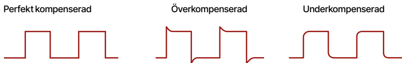
Kompensering (kalibrering) av passiv oscilloskop-prob
